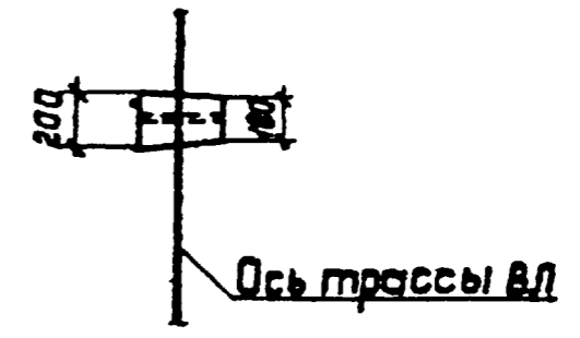
Схема установки стойки опоры
