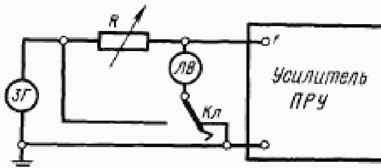
ЗГ—звуковой генератор; ЛВ—ламповый вольтметр;
