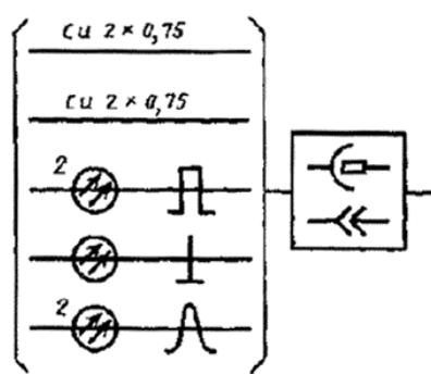
7. Передающий оптоэлектронный модуль со светодиодом с оптическим ответвителем
