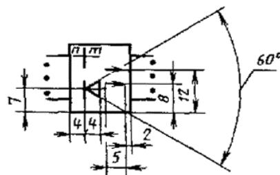
10. Оптоэлектронный передающий модуль со светодиодом
