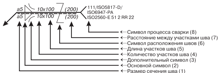
Рис. 12. Структура условного обозначения сварных соединений в соответствии с EN 22553:1994
