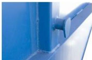
Захват сварен в пластину 8мм
