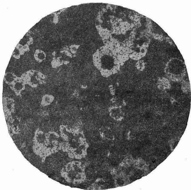
Рис. 32. Структура наплавленного металла при сварке высокопрочного чугуна порошковой проволокой марки ППВЧ-1 ( \times 120 )
