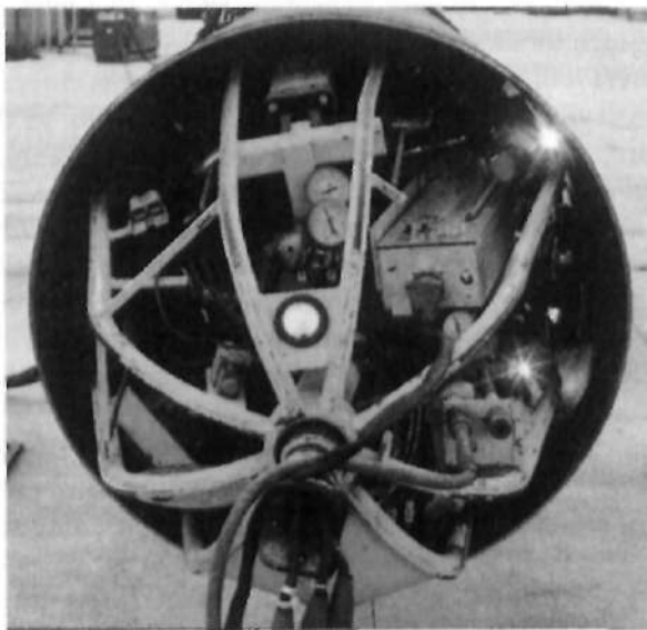
Рис. 3.58. Внутренний центратор/сварочная станция: а — вид сверху; б — вид с торца трубы
