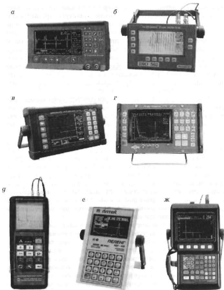
Рис. 6.5. Ультразвуковые дефектоскопы (характеристики приведены в табл. 6.3): а - USN 52R; б - DIO-562; в - УД2-70; г - УДЦ-201П; д - А1212; е - Пеленг; ж - ЕРОСН 4
