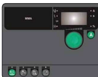
PI DC HP с функцией Synergi Plus™ Панель TIG HP поддерживает импульсный режим сварки и имеет синергетический режим Synergi Plus™
