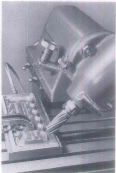
Stanzmesser für Papierdichtungen fräsen. Die Schrägflächen konnten mit normalem Schaftfräser durch Schwenken des Senkrechtfräskopfes erreicht werden
