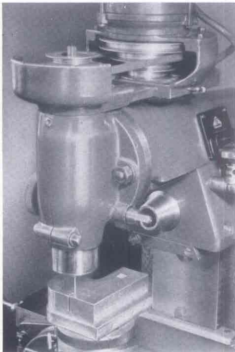
Fräsen einer Senkrechnute mit 2 mm Breite bei Verwendung der schnelllaufenden Senkrechtfresspindel mit Einschneidefräser
