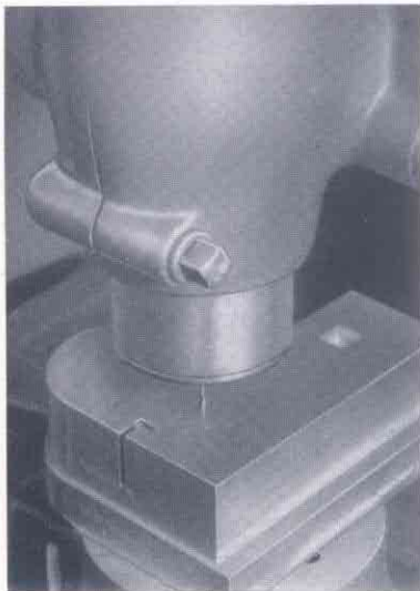
Bohren von kleinen Löchern mit Senkrecht- fräskopf
