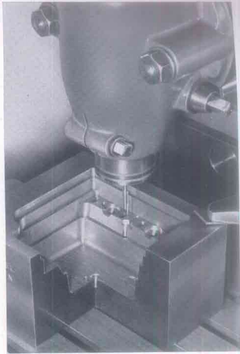
Fräsen von Schlitzern und Langlöchern mit Einschnidefräsern
