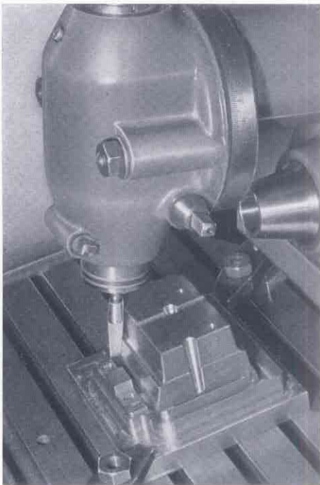
Fräsen einer schrägen Fläche mit Einschneidefräser
