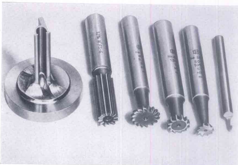
Schnittstempel mit den zur Bearbeitung benötigten Werkzeugen
