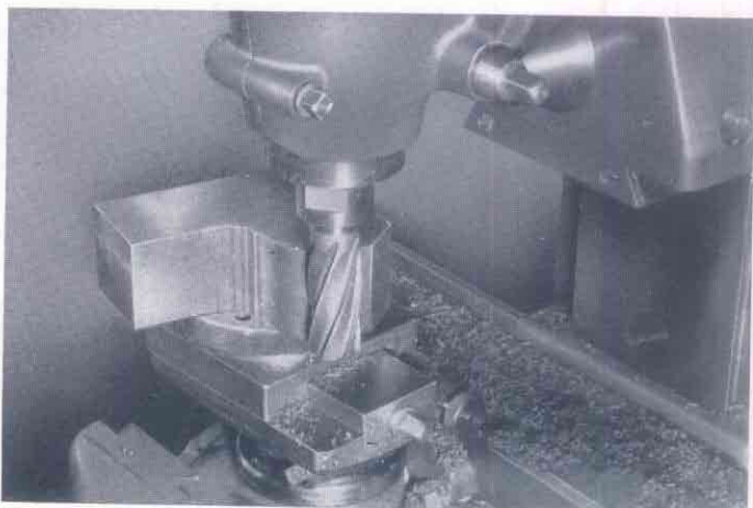
Fräsen der großen Rundung mit Schaftfräser 26 mm Ø.
