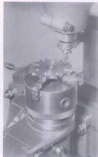
Malteseerkreuz. Fräsen und ausdrehen mit Senkrechtfrässpindel und Exzenterausdrehfutter
