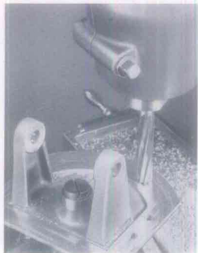
Anschraubfläche abräsen mit Senkrechtfräskopf
