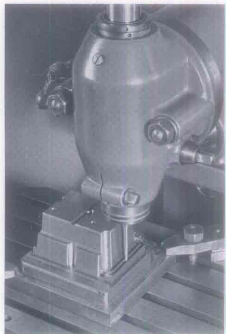
Fräsen feiner konischer Nuten mit Einschneidefräser
