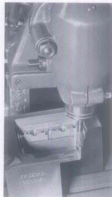
Fräsen von schrägen Innenflächen mit normalen Schaftfräsern durch Schwenken des Winkelarbeitstisches
