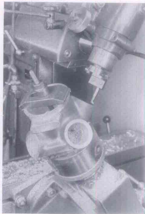
Rohrverteiler in Aluminium. Rohrstützen ausdrehen mit Exzenter-Ausdrehfutter. Senkrechtfräskopf u. Teilkopf in Schrägstellung.
