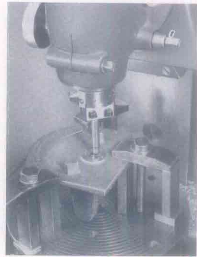
Lagerbohrung ausdrehen mit Exzenter-Ausdrehfutter
