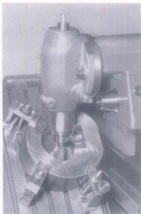
Schräge Fläche für Augen fräsen, durch Schrägstellung des Winkelarbeitstisches um 45^{\circ}
