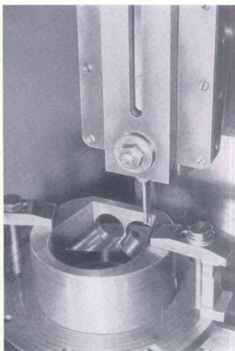
Ausstoßen von scharfen Ecken mit Stoßapparat
