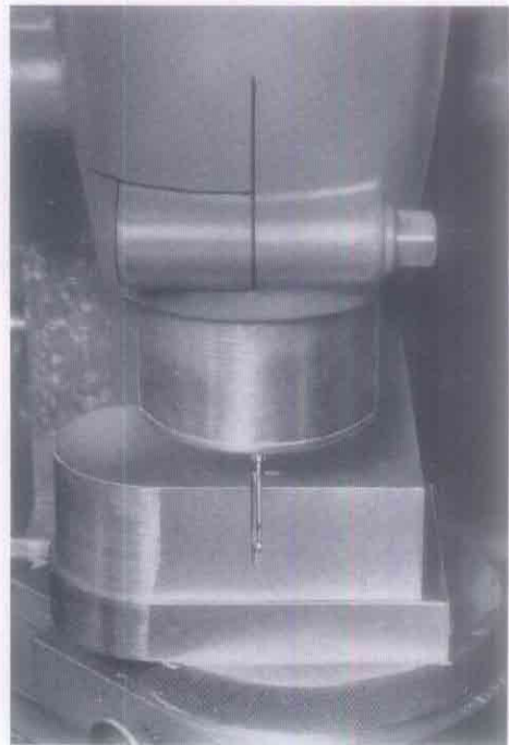
Fräsen einer Senkrechnute mit 2 mm Breite bei Verwendung der schnelllaufenden Senkrechtfresspindel mit Einschneidefräser
