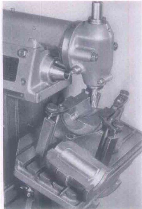
Fräsen einer Glas-Preßform für eine 8-kant Flasche. Die Bearbeitung der einzelnen Flächen erfolgt durch Schwenken des Arbeitstisches
