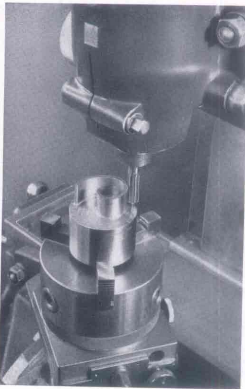
Schnittstempel und Schnittplatte mit Senkrechtfräskopf ausgearbeitet
