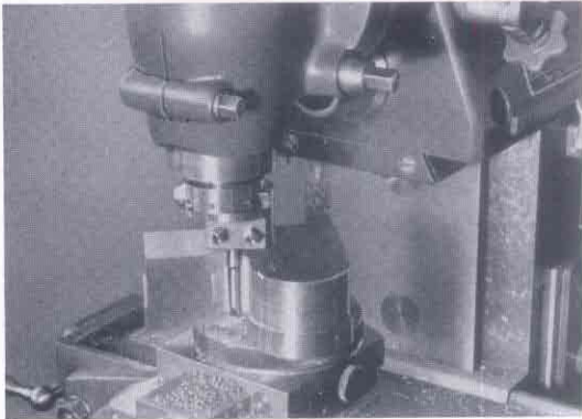
Bearbeiten der Innenrundung mit Exzenter-Ausdrehfutter
