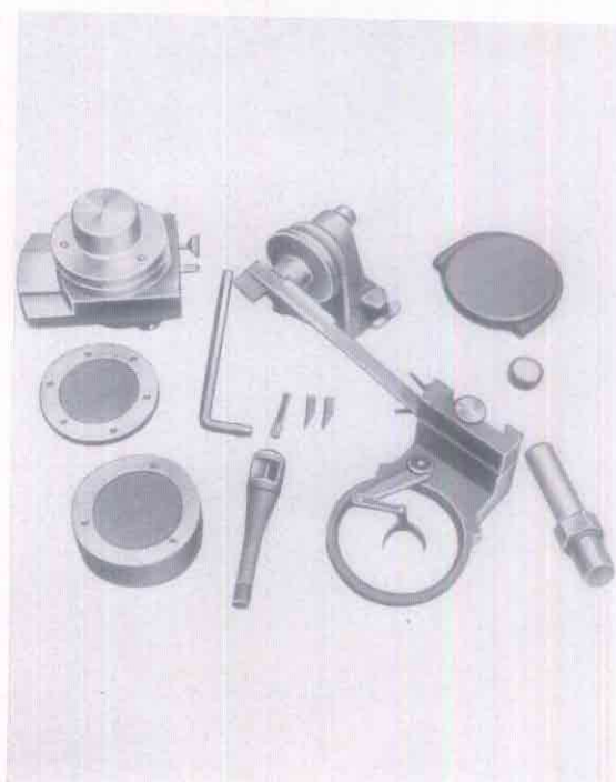
Stempellräseinrichtung FVTS Schiebefutter mit Aufspannflansche; Glasstrichplatte mit Lupenhalter und Lupe; Schiebelehre: Meßweite 130 mm; Anreißspitze und Schnabel für Innenmessung; Zentriernadel; Prüfdorn und Meßuhrhalter
