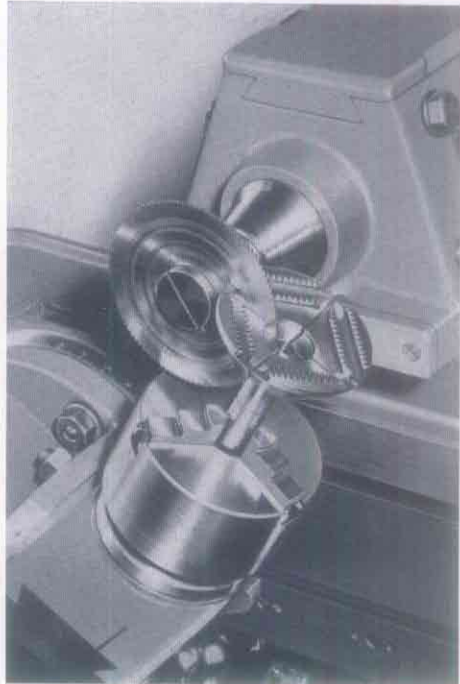
Schlitzen der Spannzange, Teilkopf 30° nach rechts geschwenkt
