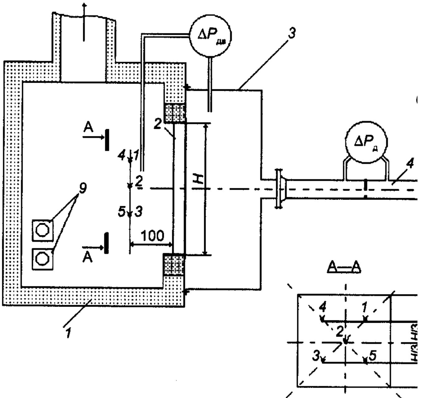
1 - печь; 2 - испытываемый образец двери; 3 - пневмокамера; 4 - стенд определения расходных характеристик инженерного оборудования; 6 - регулирующая заслонка; 7 - воздухопроводы обвязки стенда; 8 - вентилятор; 9 - форсунки;
