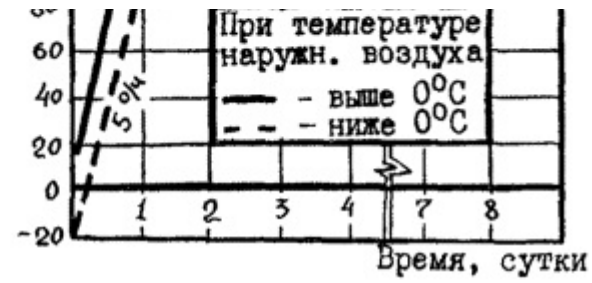
Рис. 2 Режим сушки и разогрева кирпичных дымовых труб без футеровки
