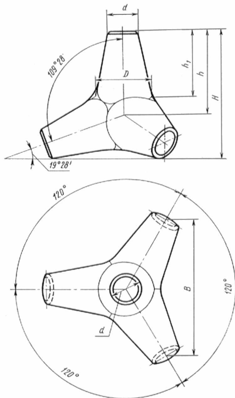
2.5. Тетраподы для берегозащитных сооружений, расположенных в приурезовой зоне побережья с галечными наносами с интенсивным волнением и подвергающихся действию льда, должны изготавляться из гидротехнического бетона марки не ниже 400 по прочности на сжатие и водонепроницаемостью не ниже В6.
