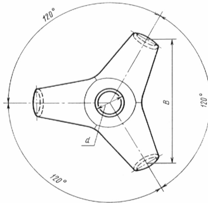
2.5. Тетраподы для берегозащитных сооружений, расположенных в приурезовой зоне побережья с галечными наносами с интенсивным волнением и подвергающихся действию льда, должны изготавливаться из гидротехнического бетона марки не ниже 400 по прочности на сжатие и водонепроницаемостью не ниже В6.
