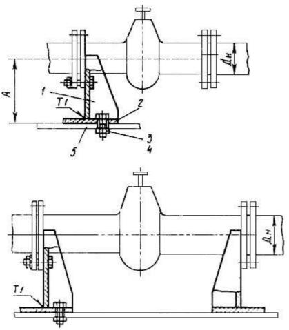
Опора для крепления арматуры Тип ОКА Для Дн=20-110 мм
