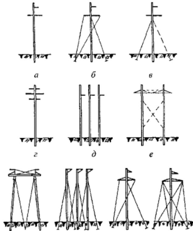
**Рис. П8.2.** Схемы железобетонных опор 35 - 500 кВ:
