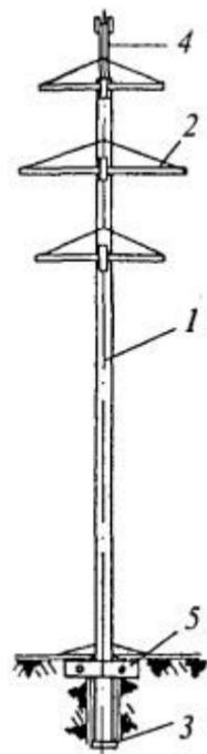
*Рис. П8.1.* Детали железобетонной свободностоящей опоры:
