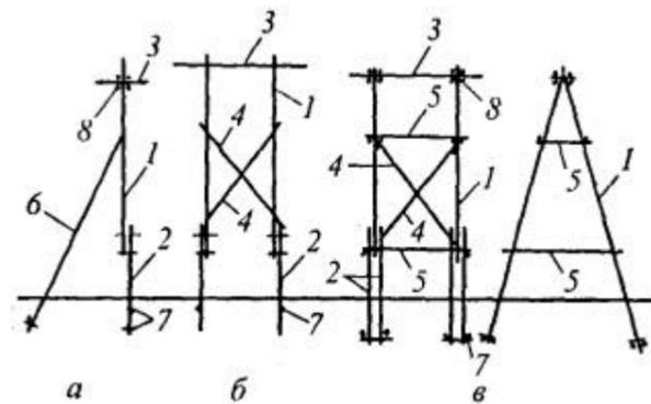
**Рис. П8.7.** Схемы деревянных опор ВЛ 35-220 кВ и их детали:
