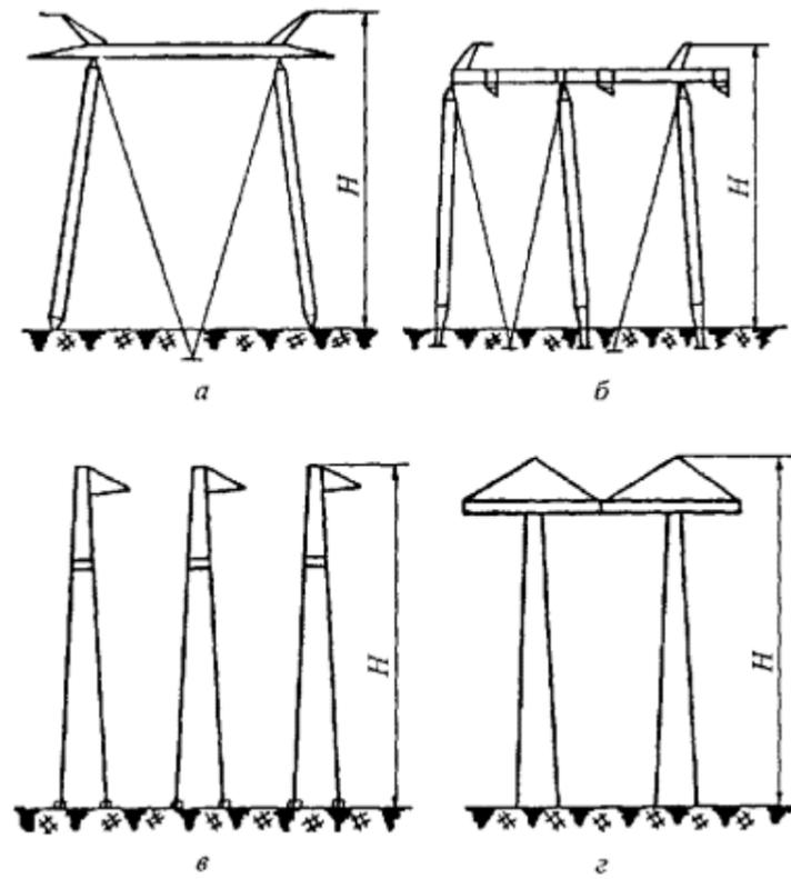
**Рис. П8.6.** Схемы металлических опор 500-750 кВ:
