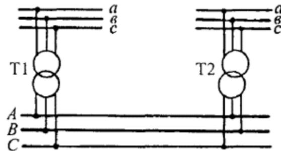
**Рис. 5.5.** Схема плавки гололеда с встречным включением фаз трансформаторов
