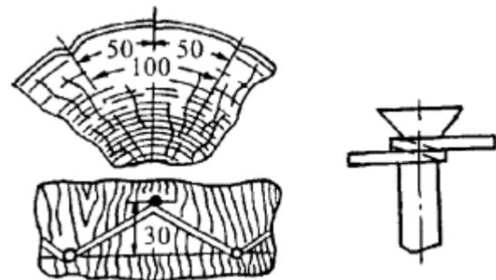
*Рис. 5.2.* Закрепление шунтирующего бандаж гвоздями
