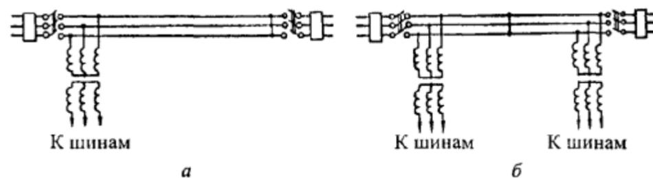
**Рис. 5.3.** Схемы плавки гололеда с замыканием трех фаз:
