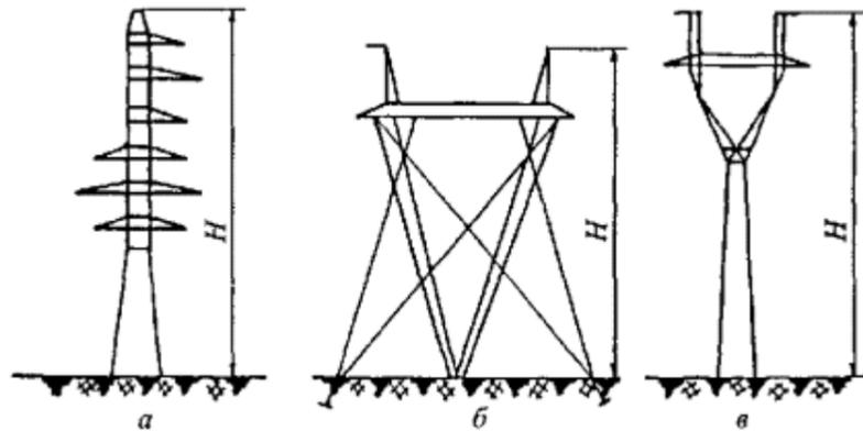
**Рис. П8.5.** Схемы металлических опор 110 и 330 кВ:
