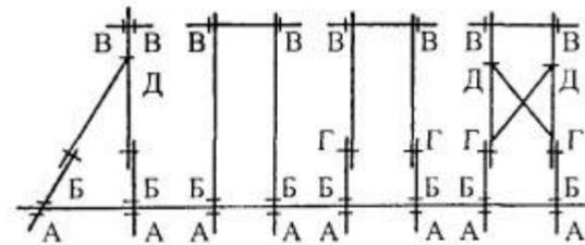
**Рис. 3.1.** Опасные сечения деревянных опор:
