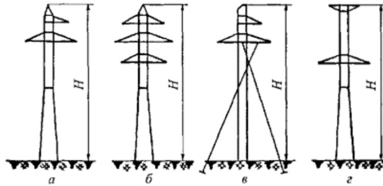
**Рис. П8.4.** Схемы металлических опор 35-330 кВ:
