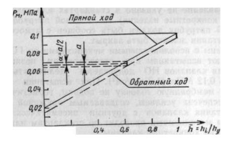
Пример определения нечувствительности для клапана с исполнительным механизмом по ГОСТ 13373-67 приведен на чертеже.
