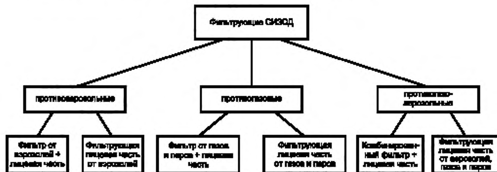
Рисунок 3 — Классификация фильтрующих средств индивидуальной защиты органов дыхания
