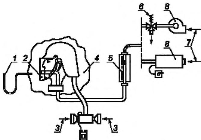
1 — к микроманометру; 2 — испытуемое изделие; 3 — подача воздуха; 4 — пластиковый мешок;
