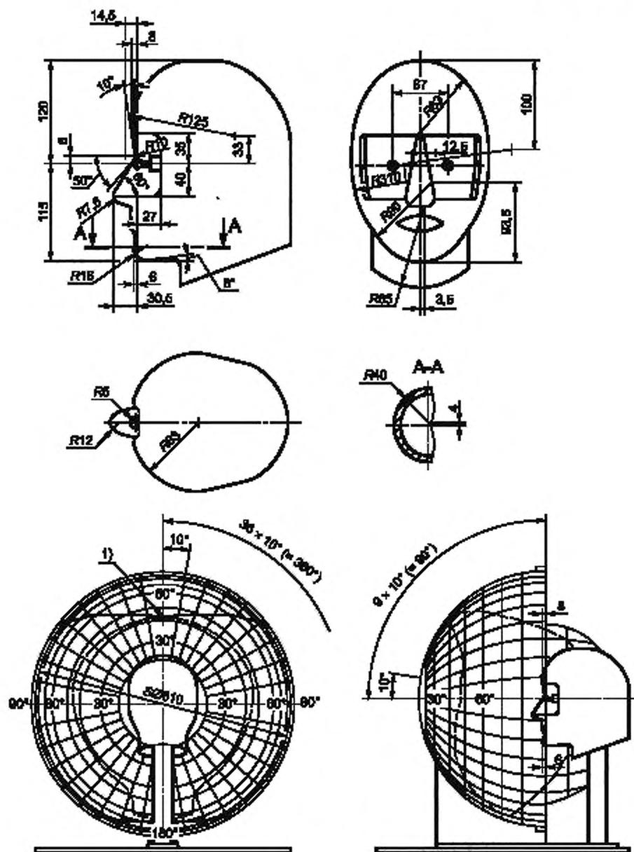
Рисунок 4 — Схема измерения площади поля зрения
