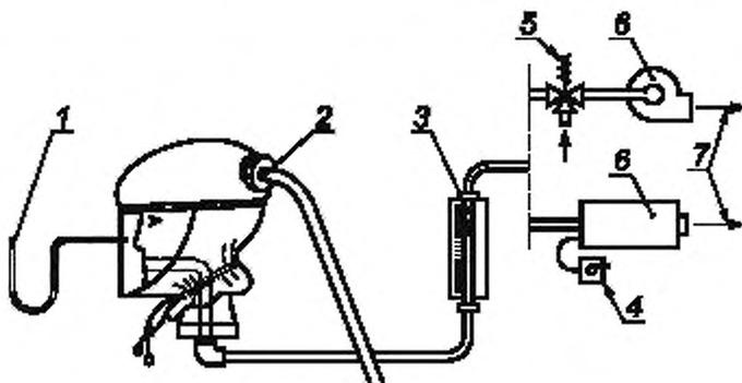
1 — к микроманометру; 2 — подача воздуха; 3 — расходомер; 4 — блок принудительной подачи воздуха;
