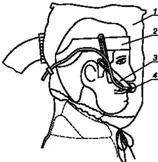
1 — испытуемый капюшон; 2 — оголовье; 3 — регулируемый пластмассовый кронштейн; 4 — пробоотборник
