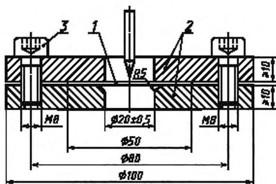
1 — элементарная проба; 2 — пластины; 3 — зажимные болты
