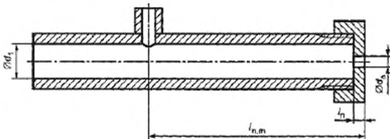
$d_n$  — диаметр отверстия сопла, равный  $(4 \pm 0,1)$  мм;  $l_n$  — длина отверстия сопла, равная  $(4 \pm 0,1)$  мм;  $d_t$  — внутренний диаметр трубы, равный  $(12,5 \pm 1)$  мм;  $l_{m,n}$  — расстояние между отверстием сопла и манометром, равное  $(80 \pm 1)$  мм
