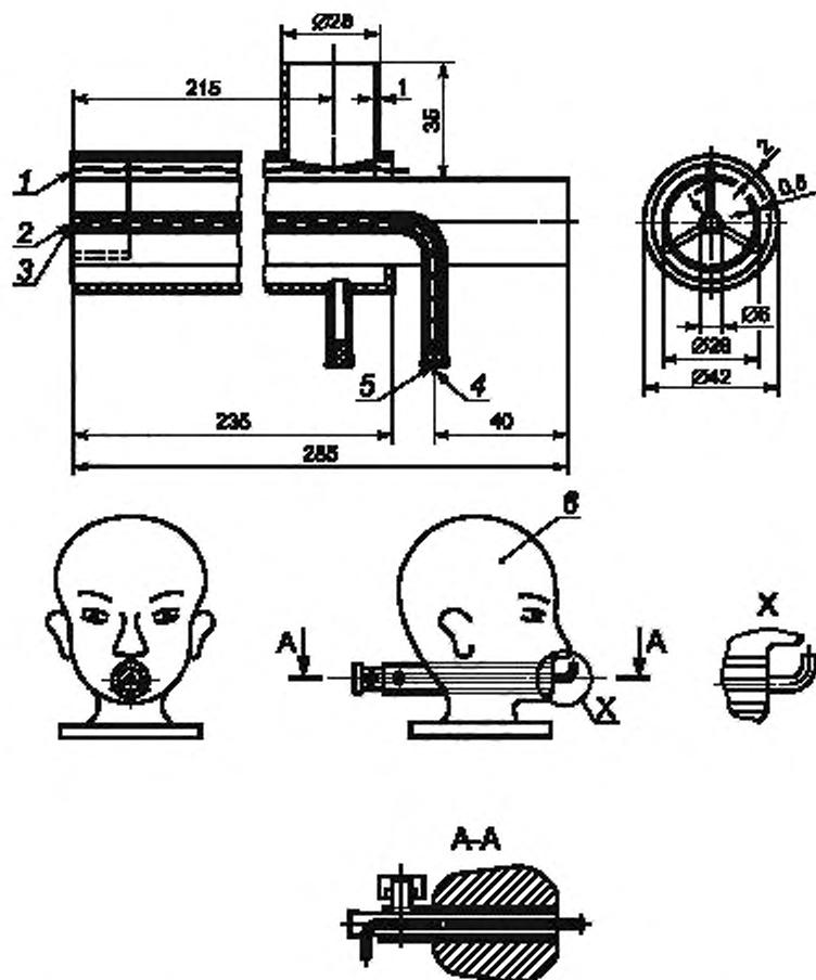
1 — точка измерения температуры на выдохе; 2 — точка измерения температуры на вдохе; 3 — точка измерения давления;
