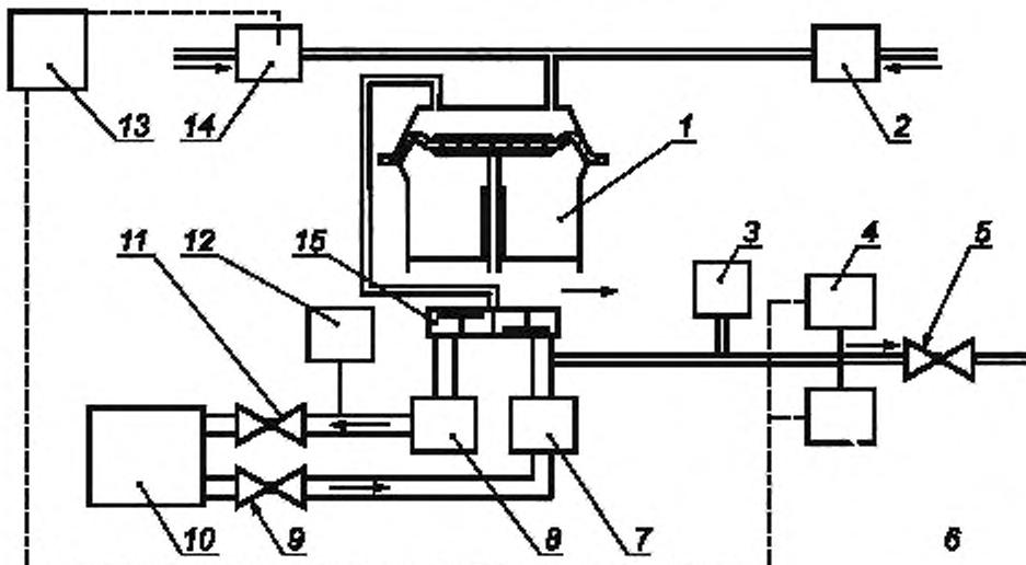
1 — насос; 2 — дозатор диоксида углерода; 3 — устройство отбора ГДС; 4 — газоанализатор диоксида углерода для выдыхаемого газа; 5 — обратный клапан; 6 — газоанализатор кислорода; 7 — холодильник; 8 — увлажнитель; 9 и 11 — отсечные клапаны; 10 — переходник; 12 — газоанализатор диоксида углерода для выдыхаемого газа; 13 — персональный компьютер; 14 — дозатор азота; 15 — клапанная коробка
