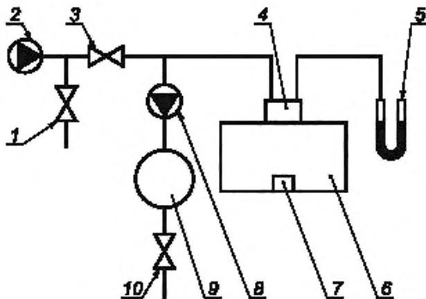
1, 3, 10 — регулирующие вентили; 2 — устройство подачи воздуха; 4 — переходник; 5 — мановакуумметр с пределом измерения до 2500 Па и абсолютной погрешностью не более  $\pm 20$  Па; 6 — самоспасатель (ДМ); 7 — КИД; 8 — источник разрежения; 9 — газовый счетчик с пределами измерения от 0,3 до 10,0  $\text{dm}^3/\text{мин}$  и относительной погрешностью не более  $\pm 1\%$ ;
