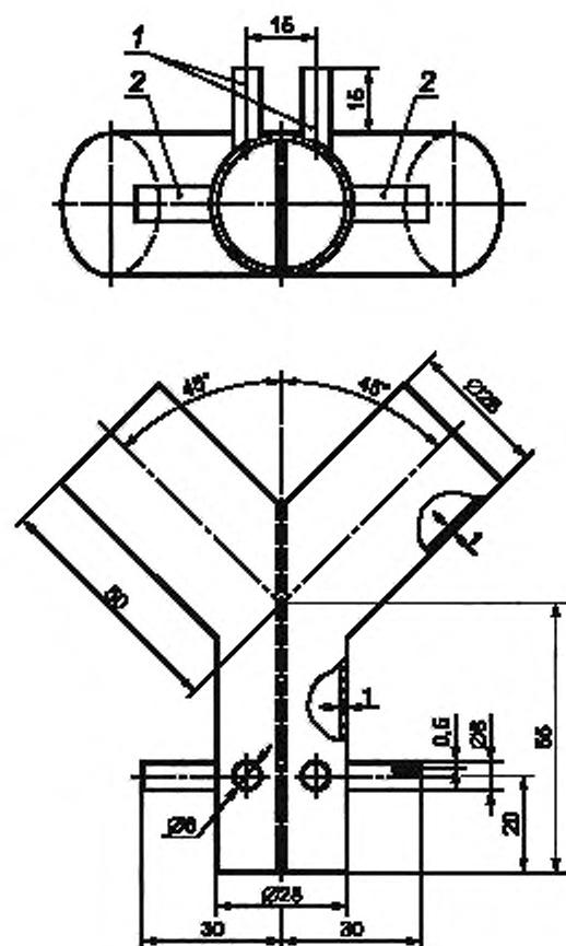
1 — штуцер для присоединения тягопаноромера; 2 — штуцер для установки термоэлектрического преобразователя
