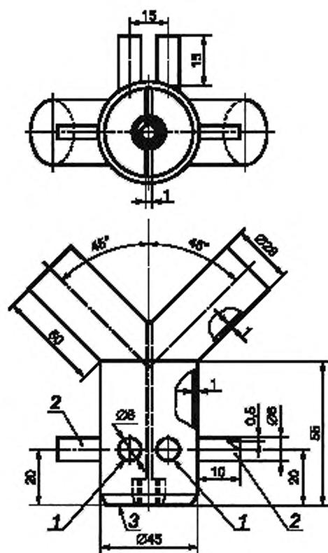
1 — штуцер для присоединения тягопорометра; 2 — штуцер для установки термозлектрического преобразователя;
