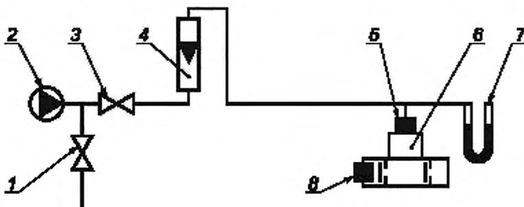
1, 3 — регулирующие вентили; 2 — устройство подачи воздуха, 4 — расходомер с верхним пределом измерения  $0,063 \text{ м}^3/\text{ч}$  и приведенной погрешностью не более  $\pm 2,5\%$ ; 5 — присоединительное устройство, 6 — клапанная коробка; 7 — мановакумметр с пределом измерения до 2500 Па и абсолютной погрешностью не более  $\pm 20 \text{ Па}$ ; 8 — пробка
