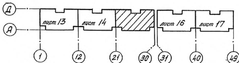
Примечание - Если чертежи участков помещены в разных основных комплектах рабочих чертежей, то над номером листа указывают обозначение соответствующего основного комплекта
