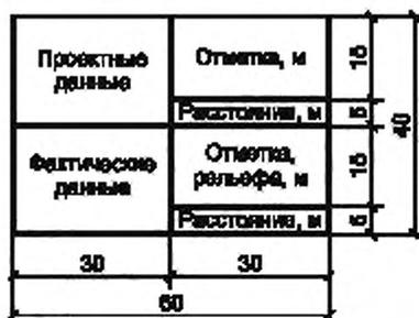
При размещении на листе двух поперечных профилей и более боковик таблицы допускается выполнять только у первого поперечного профиля.
