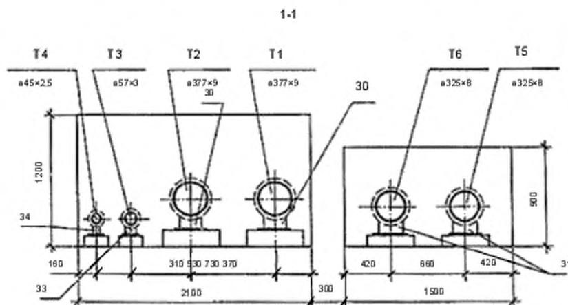
Рисунок Г.1 – Поперечный разрез при подземной прокладке
