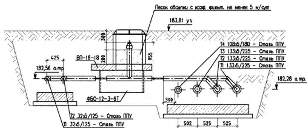
Рисунок Е.3 – Сечение узла трубопроводов при бесканальной прокладке
