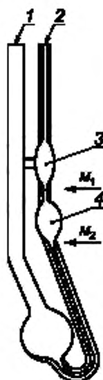
1 — трубка вискозиметра, на которую надевают резиновую трубку; 2 — трубка вискозиметра, погружаемая в нефтепродукт; 3 — расширение (находится ниже уровня жидкости в термостате), 4 — расширение, в которое засасывается испытуемый нефтепродукт
