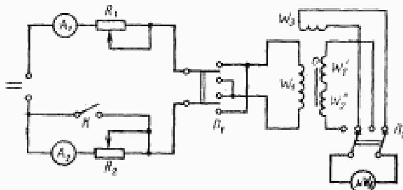
$R_1, R_2$  — регулировочные реостаты;  $A_1, A_2$  — амперметры;  $K$  — ключ;  $P_1, P_2$  — двухполюсные переключатели;  $W_1, W_2$  — катушки индукционного преобразователя для измерения магнитного потока;  $W_3$  — измерительная катушка;  $W_0$  — обмотка намагничивающего устройства;  $\mu A$  — микроамперметр;  $O$  — образец.
