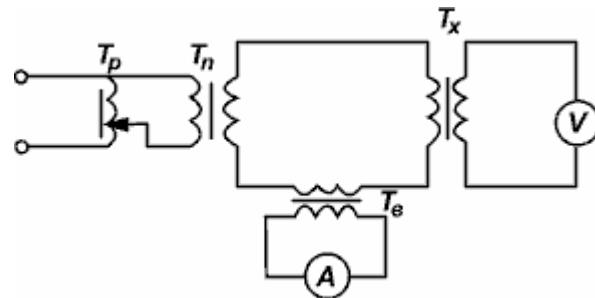
$T_p$  - регулировочный трансформатор;  $T_n$  - трансформатор питания;  $T_x$  - поверяемый трансформатор тока;  $T_e$  - вспомогательный трансформатор
