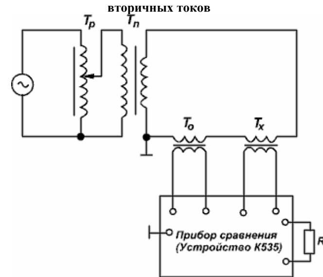
$\sim$  - сеть (генератор);  $T_p$  - регулировочный трансформатор;
