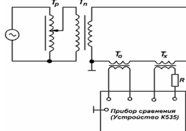
$\sim$  - сеть (генератор);  $T_p$  - регулировочный трансформатор;
