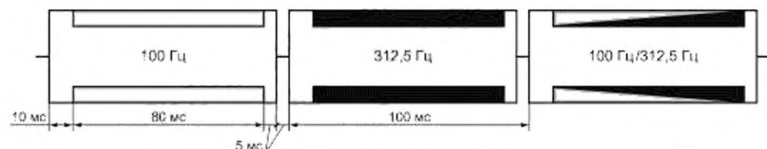
Рисунок 1 — Фрагмент структуры сигнала типа DXXXW
