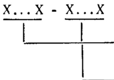
Обозначение схемы расположения конструкций и изделий состоит из одной или двух букв; при наличии нескольких схем однотипных конструкций буквенное обозначение дополняется порядковым номером.
