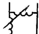
26. Автотрансформатор трехфазный с ферромагнитным магнитопроводом; соединение обмоток в звезду
