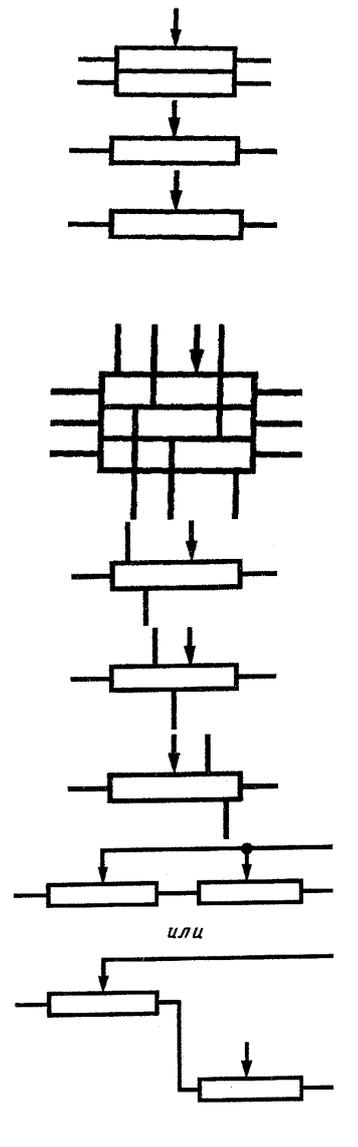
Примечание. Обозначения, установленные в табл. 2, следует применять для потенциометров, у которых подвижный контакт перемещается между двумя фиксированными (начальным и конечным) положениями. При этом конструктивное исполнение потенциометра может быть любым: линейным, кольцевым или спиральным (многооборотные потенциометры).
