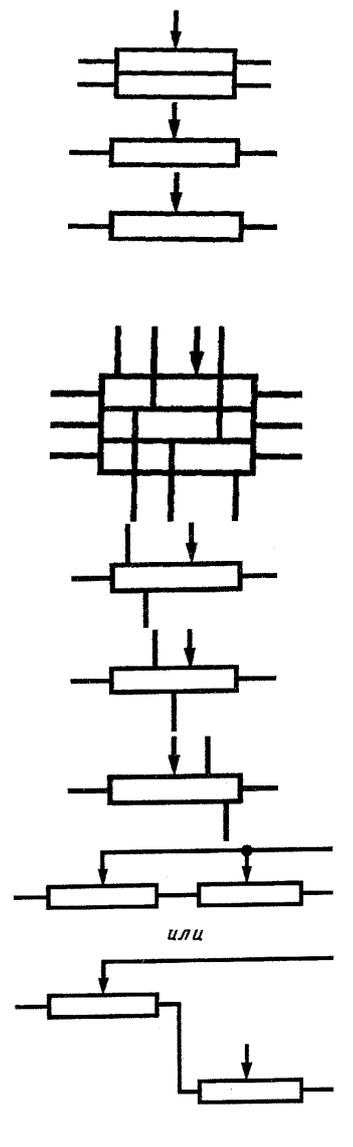
Примечание. Обозначения, установленные в табл. 2, следует применять для потенциометров, у которых подвижный контакт перемещается между двумя фиксированными (начальным и конечным) положениями. При этом конструктивное исполнение потенциометра может быть любым: линейным, кольцевым или спиральным (многооборотные потенциометры).
