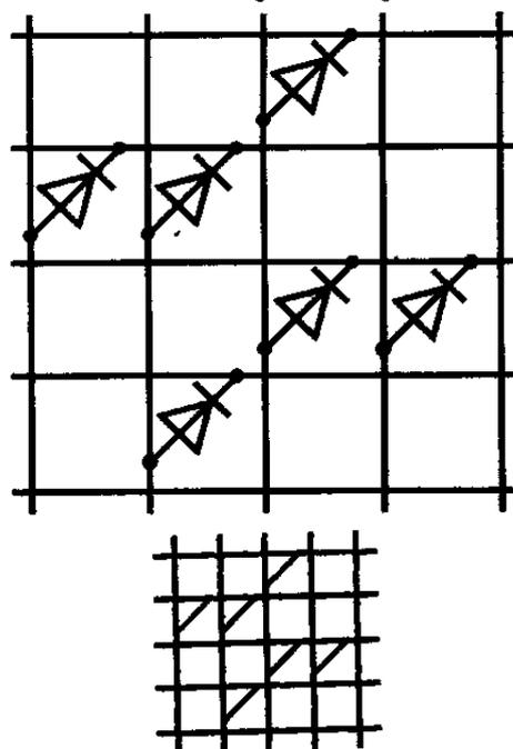
14. Условные графические обозначения полупроводниковых приборов для схем, выполнение которых при помощи печатающих устройств ЭВМ предусмотрено стандартами Единой системы конструкторской документации, приведены в табл. 13.
