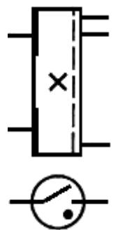
15. Пускатель для газоразрядных ламп
