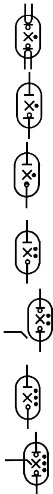
а) лампа газоразрядная низкого давления с простыми электродами и самокалиющимся катодом
