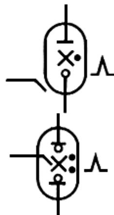
8. Лампа газоразрядная импульсная:
