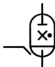
7. Лампа газоразрядная с жидким катодом и наружным поджигом
