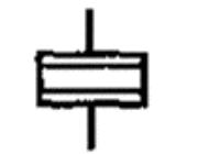
20. Катушка электромеханического устройства, работающего с механическим резонансом
