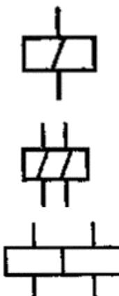
4. Катушка электромеханического устройства с  $n$  обмотками
