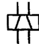
6. Катушка электромеханического устройства с двумя встречными одинаковыми обмотками (бифилярная обмотка)
