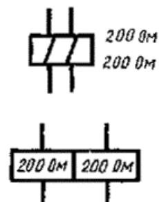
2. Если катушку электромеханического устройства с несколькими обмотками разносят на схеме, то каждую обмотку изображают следующим образом:
