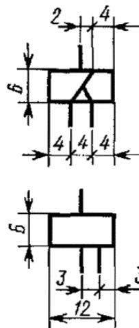
5. Катушка электромеханического устройства: с одним дополнительным графическим полем
