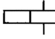
2. В дополнительном графическом поле указывают уточняющие данные электромеханического устройства, например, электромагнит переменного тока
