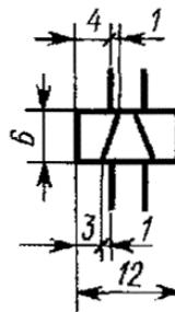
4. Катушка электромеханического устройства с одним отводом
