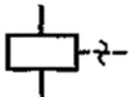
Примечание. Допускается около обозначения указывать резонансную частоту
