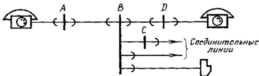
*A* - ступень предварительного искажения; *B* или *BC* - ступень группового искажения; *D* - ступень линейного искажения
