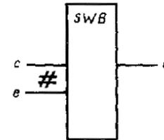
5.3. Двухнаправленный коммутатор, управляемый логическим элементом И с двумя цифровыми входами
