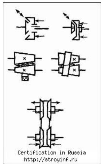
г) с криволинейными образующими рабочих тел и наклоняющимися роликами регулируемые
