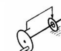
17. Маховик с фиксацией установленного положения на корпус
