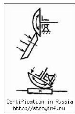
ж) с цилиндрическими роликами, преобразующие вращательное движение в поступательное
