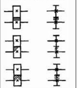
б) то же, с прямыми, косыми и шевронными зубьями
