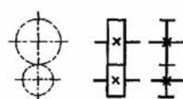
35. Передачи зубчатые (цилиндрические):
