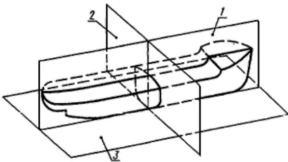
1 - диаметральной плоскости; 2 - плоскости мидель-шпангоута; 3 - основной плоскости
