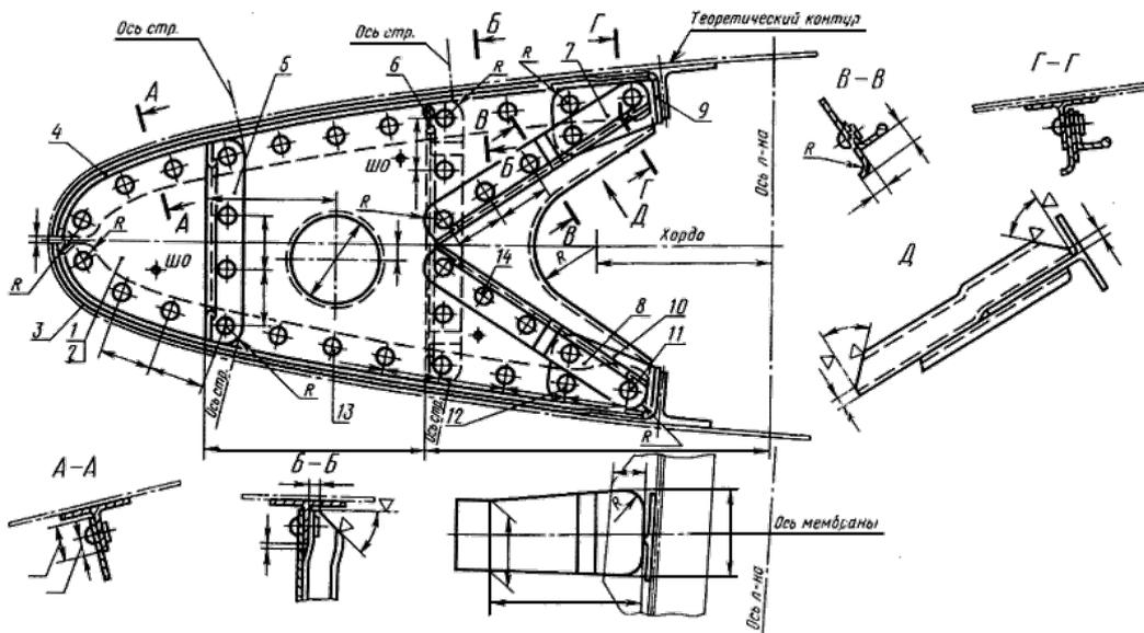
Контур и малки дет. 1-8 выполнять по шаблонам, снятым с плаза.
