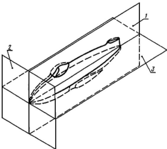
1 - плоскости симметрии, 2 - плоскости дистанции 0; 3 - плоскости строительной горизонтали
