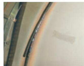
**BÖHLER EAS 4 PW-FD** с самоотделяющимся шлаком и радиографически плотным наплавленным металлом.
