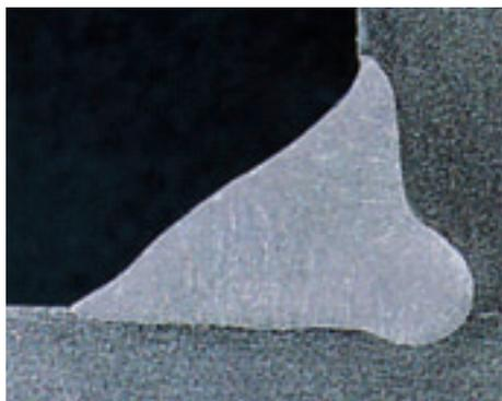
**Проволока сплошного сечения  $\varnothing$  1,2 мм**
