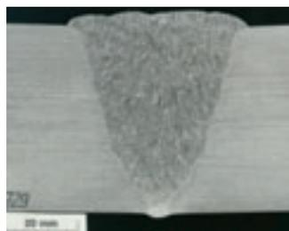
Макро сечение толщины стенки от 49 мм S 31803; дуплексная труба из нержавеющей стали – сварка при строительстве офшорных объектов.
