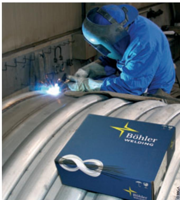
Порошковая сварочная проволока BÖHLER на катушках с проволочным каркасом, упакованная под вакуумом во влагозащитные пакеты с алюминиевым покрытием.
