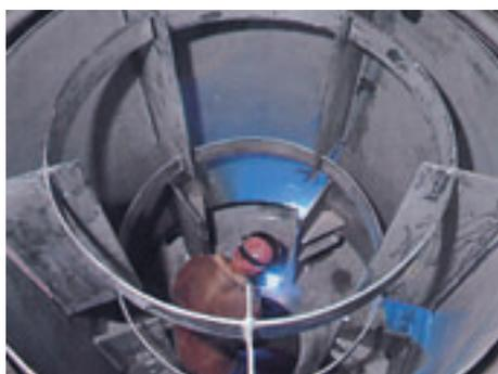
Порошковая проволока BÖHLER для сварки изделий из нержавеющей стали, аналогично хорошо знакомым электродам с рутиловым покрытием, позволяет получить наплавленный металл с превосходным качеством поверхности шва. Высокое качество сварного соединения подтверждается радиографическим контролем, при отсутствии брызг и отличной смачиваемости. Шлак предохраняет сварочную ванну от окисления и легко удаляется, оставляя гладкую поверхность шва, требующую минимальной послесварочной зачистки.
