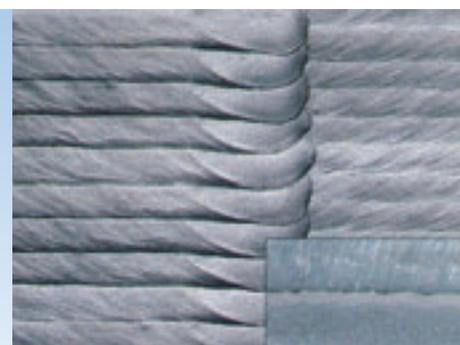
Наплавка, выполненная порошковыми проволоками BÖHLER CN 23/12 Mo-FD (1<sup>я</sup> слой) и BÖHLER EAS 4M-FD (2<sup>я</sup> слой). Идеальное применение для нержавеющей порошковой проволоки, обеспечивающей равномерное содержание ферритной фазы в наплавленном слое и оптимальную коррозионную стойкость.
