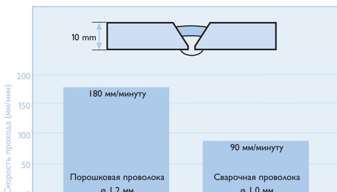
Стыковой сварной шов, 2<sup>ой</sup> слой, 3G - снизу вверх, свариваемый металл UNS S 31803, 10 мм пластина
