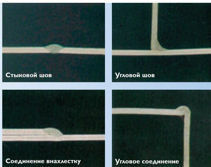
Сварные соединения на листовом металле толщиной 2 мм
