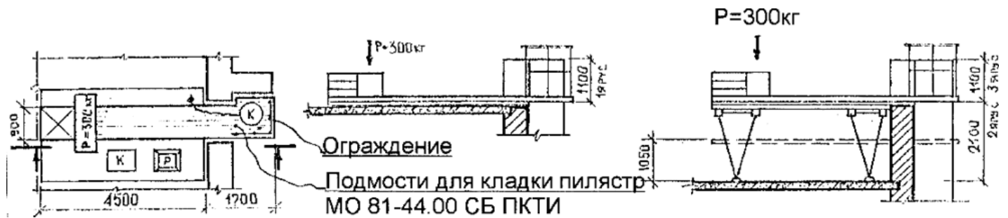
Рис.30. Кирпичная кладка пилястр
