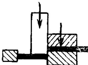
графу «Определение» изложить в новой редакции для пунктов: 10 — «Полное отделение изделия от исходной заготовки по замкнутому контуру путем сдвига»;
