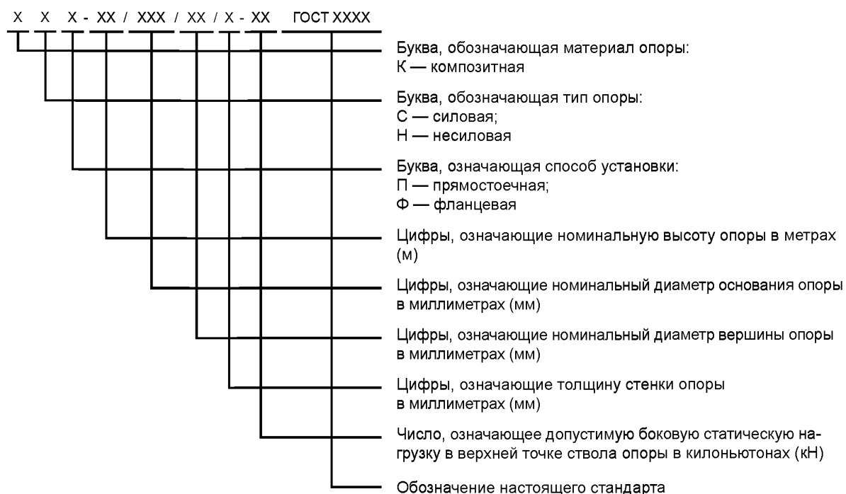
Рисунок 4.3 — Структурная схема маркировки композитных опор
