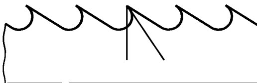
Рисунок 8 — Форма с положительным передним углом
