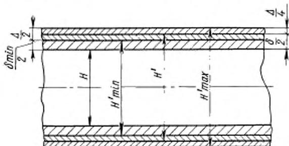
$H$  — обдирочный размер заготовки или номинальный размер детали;  $\delta_{\min}$  — наименьший припуск на размер  $H$ ;
