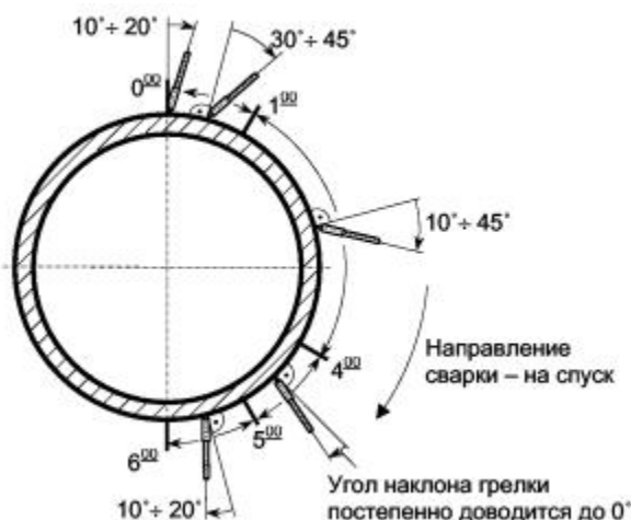
Рисунок 10.7 - Положение сварочной горелки при механизированной сварке корневого слоя шва проволокой сплошного сечения в углекислом газе методом STT в различных пространственных положениях
