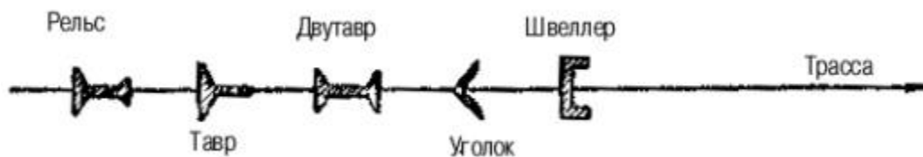
Рис. 4. Ориентация по отношению к трассе нестандартных металлических знаков различных профилей
