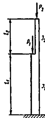
Рис. 21. Схема одноступенчатой колонны
